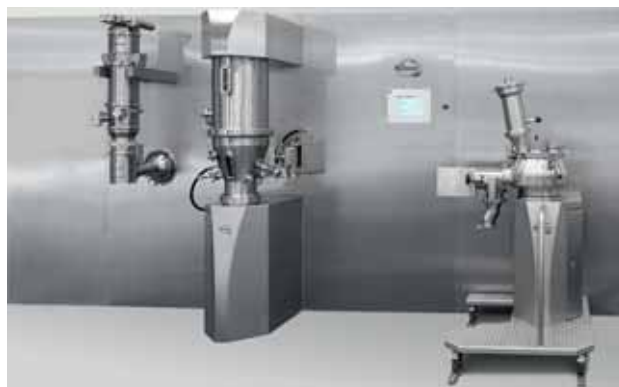
Abb. 4: Granulierlinie mit „Durch-die-Wand“-Konzept (Quelle: Diosna).
